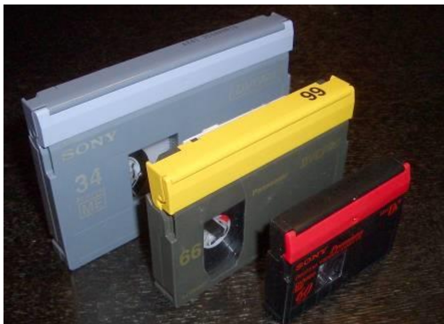
Odnosi gabarita formata BETACAM / DVCPRO / miniDV
